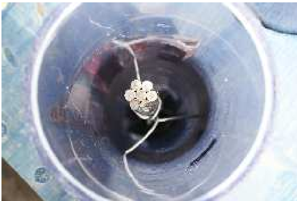
Obr. 1 pohled shora do sedimentační trubice s vloženou výztuží dle ČSN EN 445, 4.5 Zkouška se svislou trubicí
